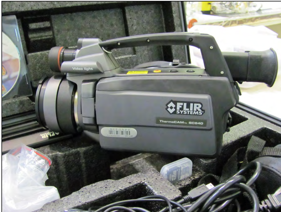
Figura 10.1 – Câmera de infravermelhos ThermoCAM SC640 utilizada nos testes.
