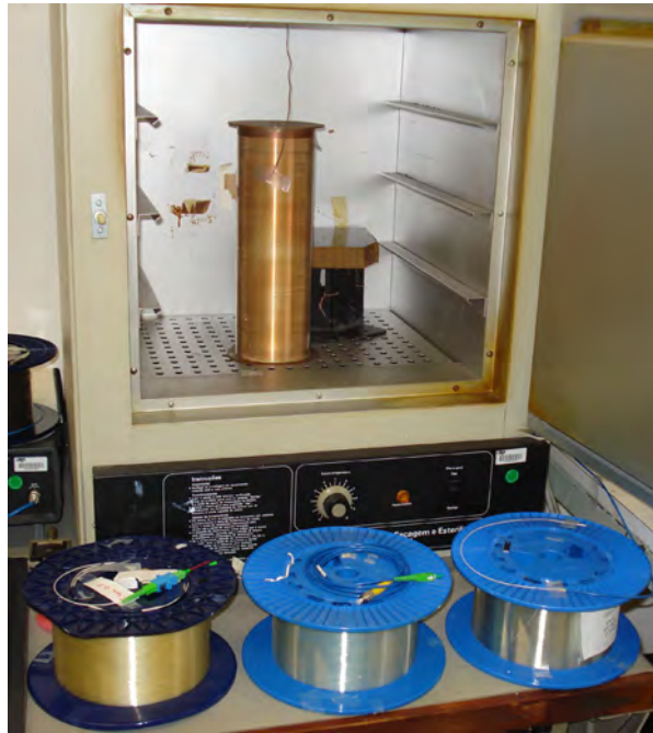
Figura 5.7: Fotografia do carretel de cobre no interior da câmara e do enlace de fibras utilizada nos experimentos para obtenção das curvas de temperatura.
