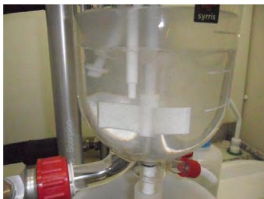
Figura 6.6 - Corrosão química da amostra de silício.
