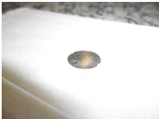
Figura 6.4 - Lâmina de silício corroída quimicamente.
