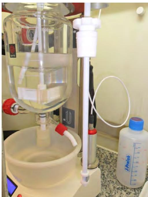
Figura 6.3 - Reator na etapa pré-corrosão.
