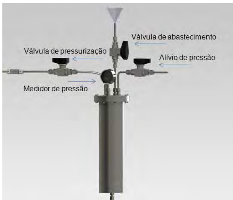
Figura 3.6 – Tanque de peróxido de hidrogênio
