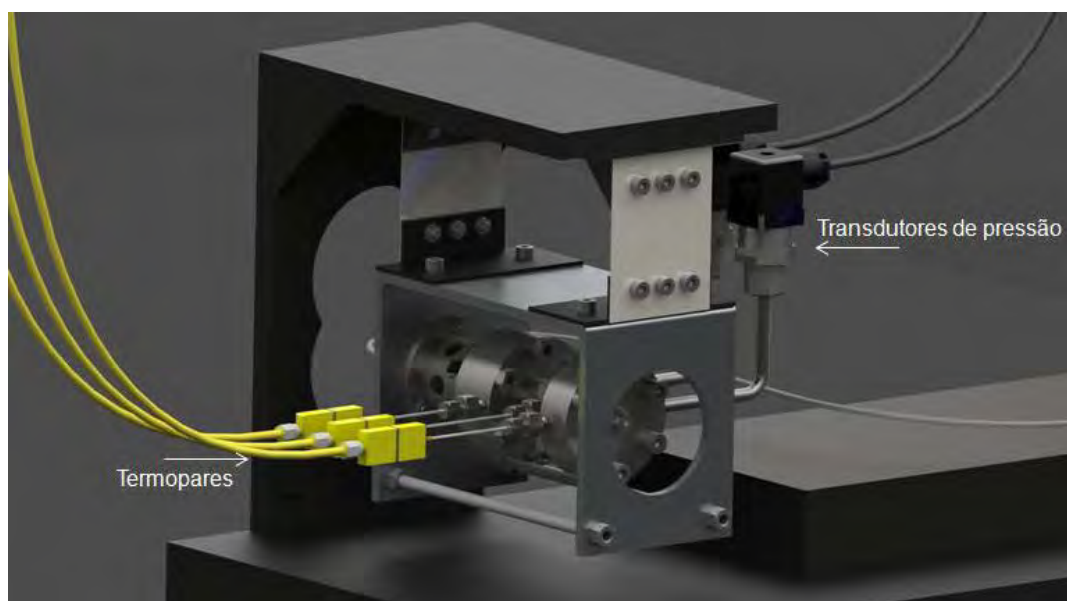
Figura 3.7 – Vista frontal da balança de empuxo
