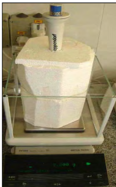
Figura 3.1: Dispositivo de controle de massa da solução de impregnação
