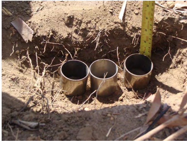
Figura 4.2 - Fotografia de campo ilustrando procedimento de coleta de amostras de solos com três repetições.
