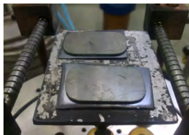
Fig. 3.9- Máscara sobre o substrato de Si
