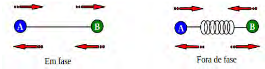
Figura 2.5 - Representação esquemática dos modos normais de oscilação presentes na rede diatômica. À direita, tem-se a representação do modo óptico. À esquerda, tem-se a representação do modo acústico. As setas representam as direções instantâneas do movimento.
