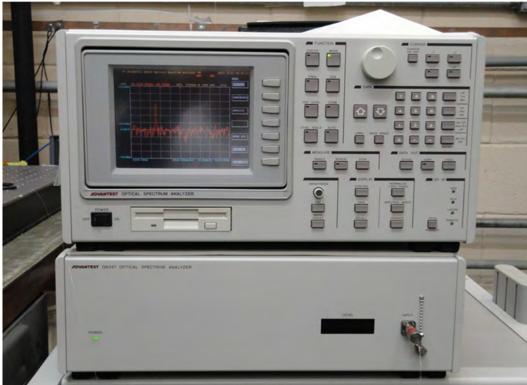
Figura 3.2 - Analizador de Espectro Óptico (utilizado para obter os espectros analisados neste trabalho), com resolução espectral na região do infravermelho de 5 \times 10^{-3} nm e com canal de entrada para fibra óptica monomodo.
