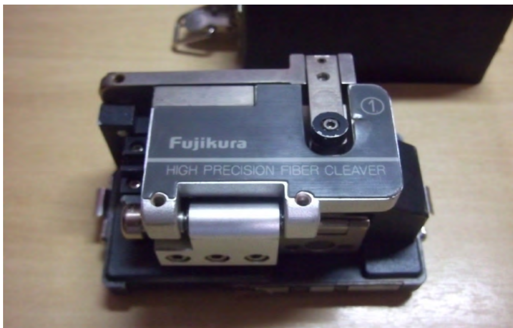
Figura 3.4 - Clivador de fibra óptica utilizado neste trabalho. Ele tem dimensões de cerca de 10cm x 5cm x 5cm.
