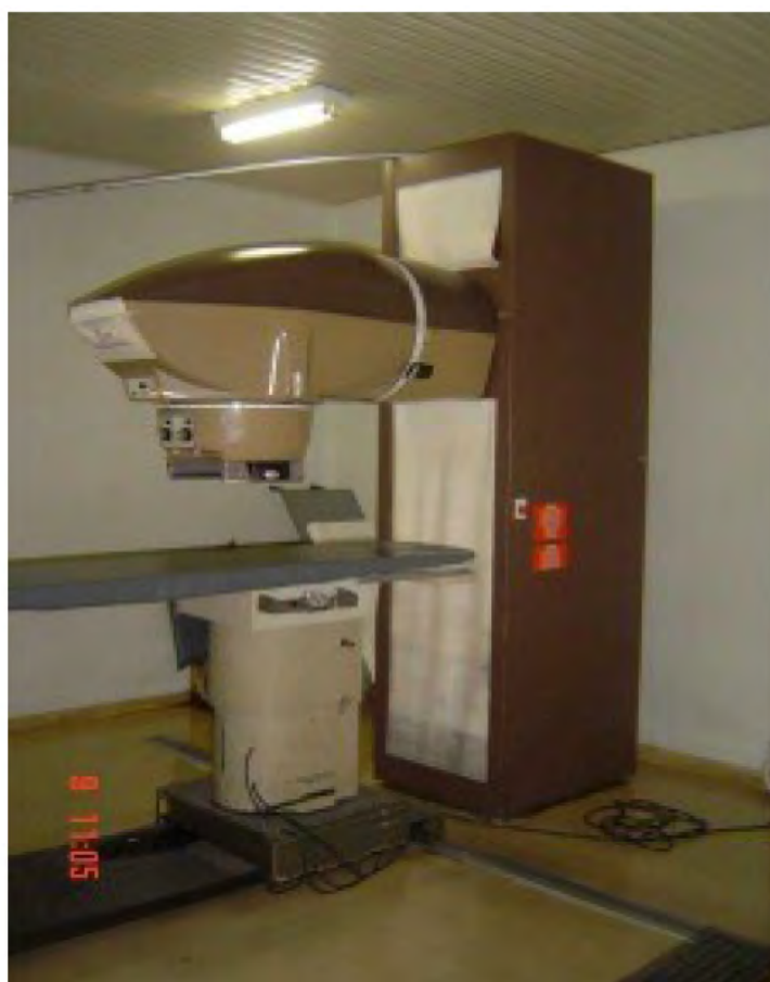
Figura 3.5 - Foto da bomba de Cobalt-60 utilizada para irradiar as fibras ópticas utilizadas neste trabalho.
