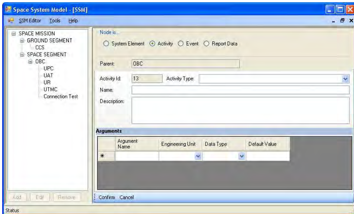
Figura C.10 – Protótipo de uma interface gráfica para gerenciamento da modelagem de um SSM
