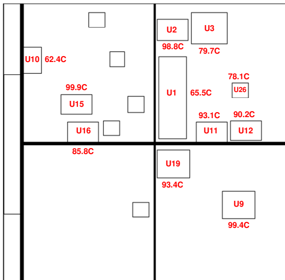
Figura 6.39 – Posicionamento para PCA LTU BAPTA com Dummies M-GEO (sol 324.739).
