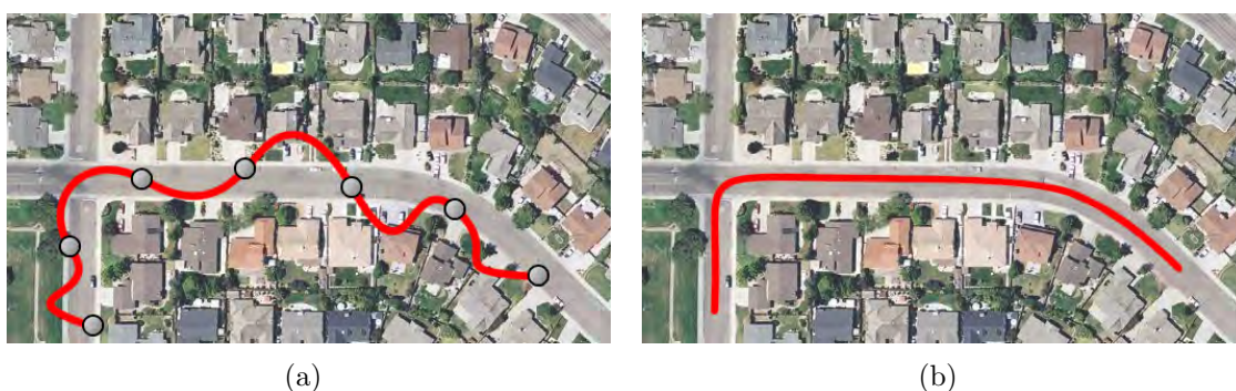
Figura 2.5 - Ilustração da aplicação de Snakes com curva aberta para a identificação de estradas: (a) Interpolação inicial. (b) Evolução final da curva em um processo de obtenção do eixo de simetria.
