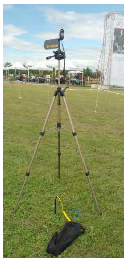
Figura 3.2 - Estação meteorológica móvel montada no local das competições. Contém sensores de temperatura e umidade, uma ventoinha para medição da velocidade do vento e uma pá para identificar sua direção. Termômetro de solo medido a temperatura na superfície e a 20 cm de profundidade.
