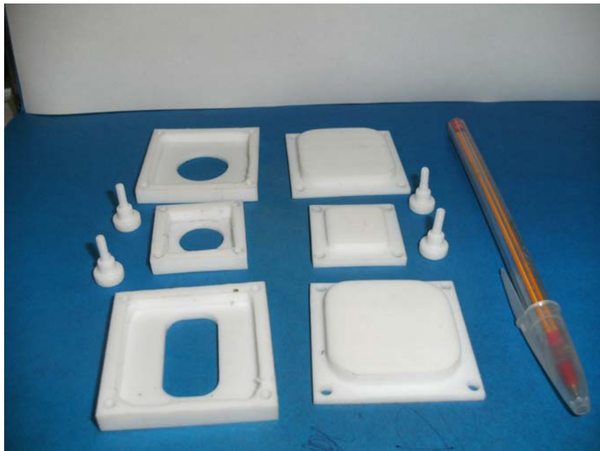
Figura 3.15 - Dispositivos usados durante os processos de corrosão em diferentes formatos
