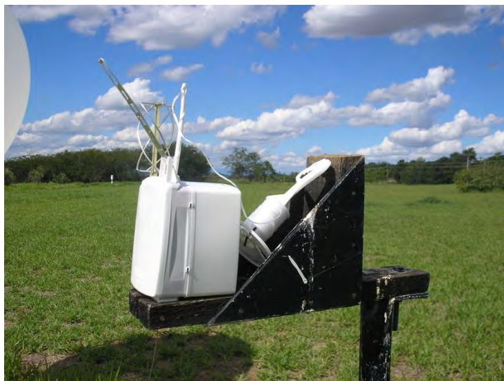
Figura 3.5 - Modelo de radiossonda RS92 utilizada nos experimentos de campo.
