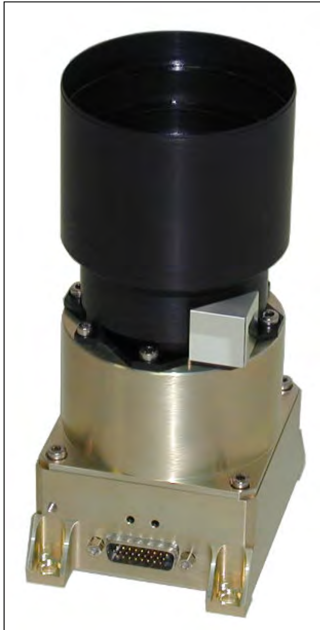
Figura 2.6 - Sensor de Estrelas VST-41M
