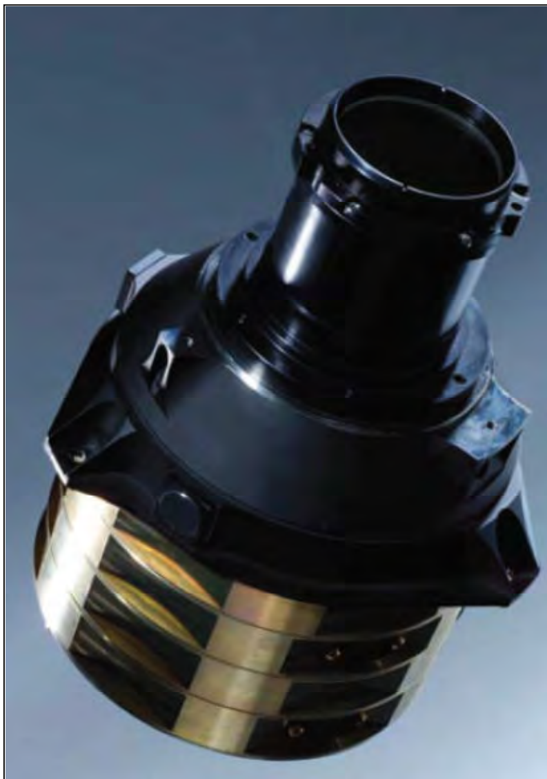
Figura 2.5 - Sensor de Estrelas ASTRO 15
