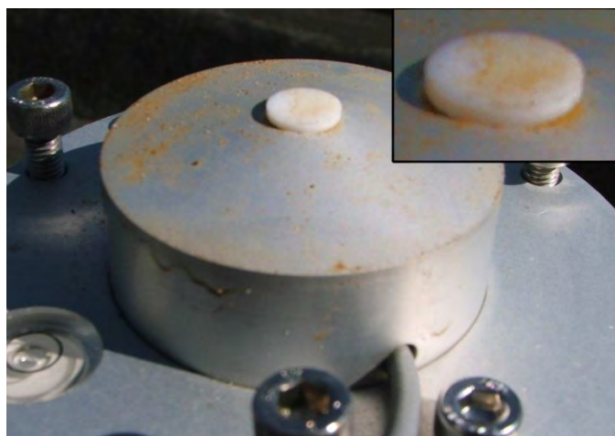
Figura 4.55 - Difusor do radiômetro LAS após 3 meses de operação.
