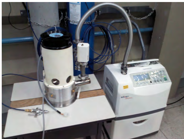
Figura 7.3 - Teste realizado no LAP/INPE com o detector de He.
