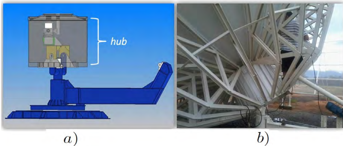
Figura 8.3 - a) projeto do hub com receptor e braço/base da antena; b) estrutura da antena e no centro da dela o hub .
