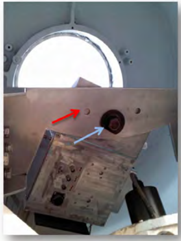
Figura 8.4 - Imagem do interior do hub com o banco de alumínio (adaptador) fixado no eixo central da antena. A seta vermelha indica o pino de referência escolhido para esta configuração e a seta azul indica o pino central com rosca responsável pela fixação do receptor no banco.
