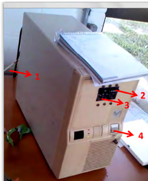
Figura 8.2 - Imagem da caixa da disjuntores onde: 1) conexão serial RS232, 2) disjuntor de alimentação do motor de azimute, 3) disjuntor de alimentação do motor de elevação, 4) disjuntor de alimentação da caixa de aquisição.
