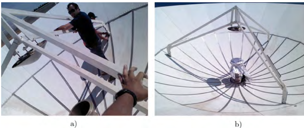
Figura 4.3 - a) vista do refletor primário (maior); b) secundário (menor), tripé e corneta coberta.
