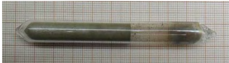
Figura 6.13 - Liga de PbSn eutético dentro da ampola de quartzo.
