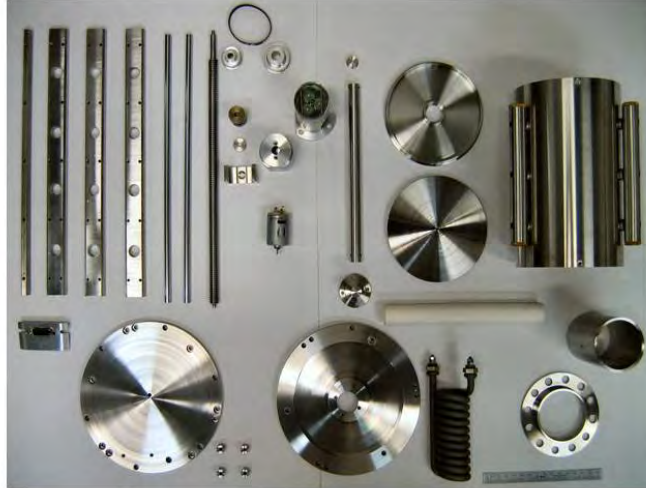
Figura 5.6 - Foto mostrando os diversos componentes mecânicos do forno de microgravidade.
