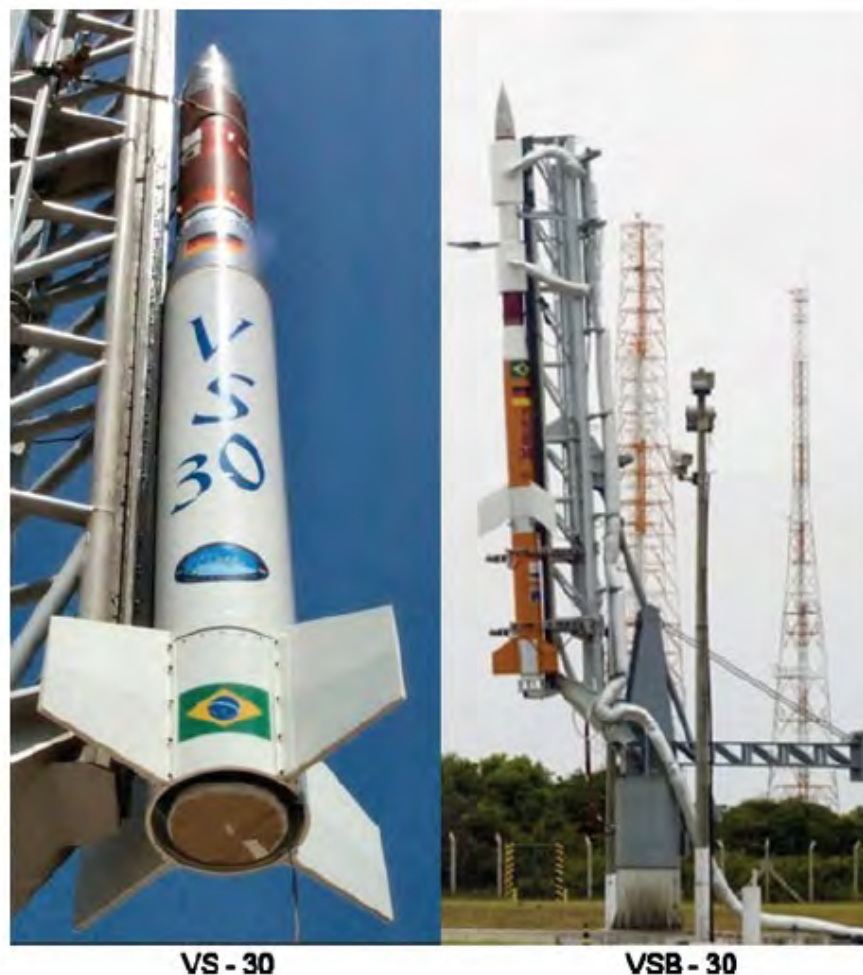
Figura 2.21 - Foguetes de sondagem brasileiros feitos no IAE. O VS-30 foi utilizado no 1º voo e o VSB-30 foi utilizado no 2º e 3º voos.
