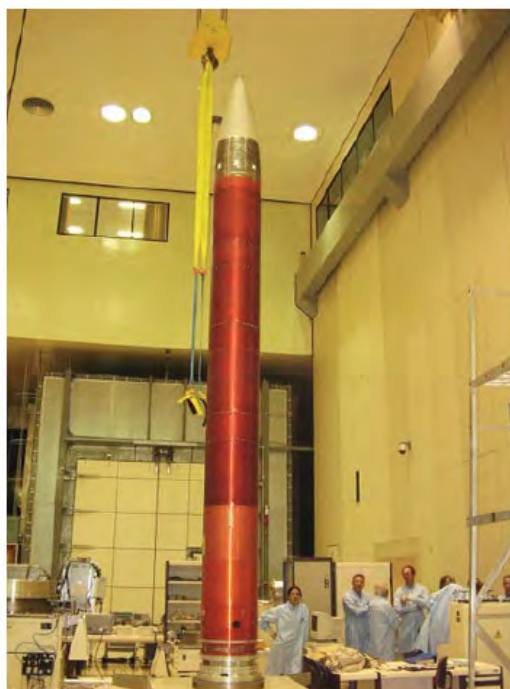
Figura 2.22 - Carga útil do VSB-30 em testes no LIT/INPE. Fonte: An et al. (2011).
