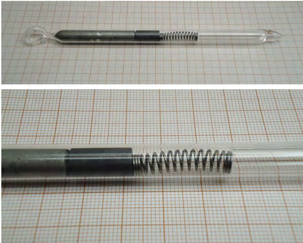
Figura 4.8 - Ampola utilizada na técnica de solidificação direcional vertical inversa.
