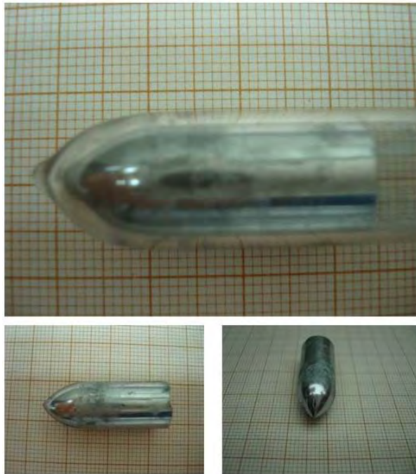
Figura 5.20 - Amostra de PbSn solidificada em ambiente de microgravidade dentro e fora da ampola.
