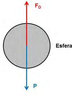
Figura 6.11 - Balanço das forças atuando na gota durante a queda.
