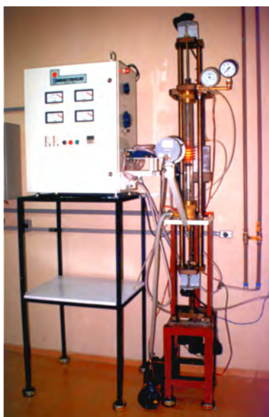
Figura 4.1 - Forno utilizado para técnica de solidificação direcional vertical. Fonte: Caram (2012).
