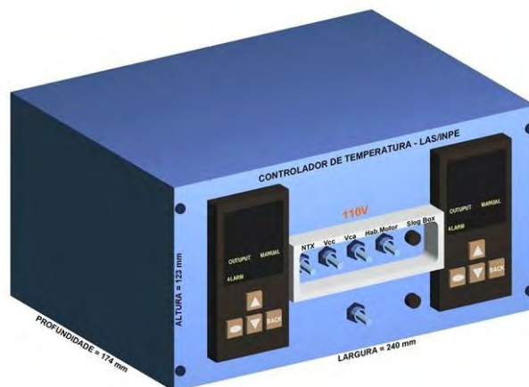
Figura 5.10 - Controlador de temperatura do forno de microgravidade. Fonte: An et al. (2009).
