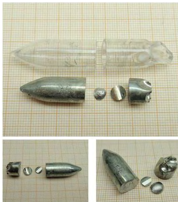
Figura 5.21 - Amostra de PbTe solidificada em ambiente de microgravidade já retirada da ampola. Nota-se que, nesse caso, a amostra foi separada em duas partes principais.
