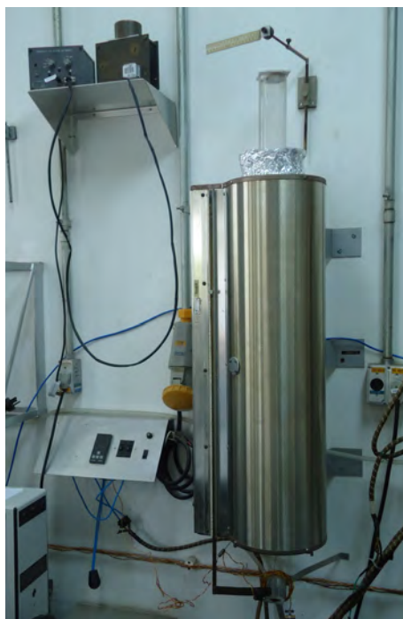
Figura 4.6 - Aparato da técnica de solidificação direcional vertical inversa do LAS/INPE.
