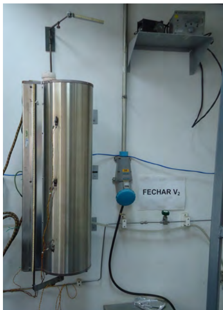
Figura 4.5 - Aparato da técnica de solidificação direcional vertical convencional do LAS/INPE.
