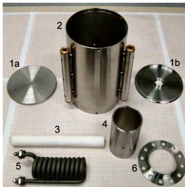
Figura 5.7 - Corpo principal do forno: (1a) e (1b) tampa superior e inferior; (2) forno; (3) tubo cerâmico; (4) tubo refletor de calor; (5) resistência blindada; e (6) anel fixador.
