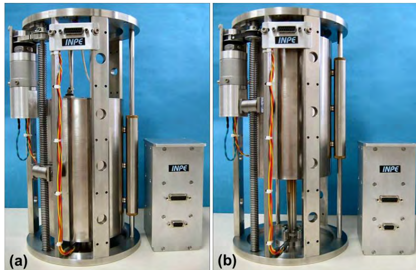
Figura 5.2 - Forno e módulo de controle: (a) posição de lançamento e (b) posição em microgravidade.
