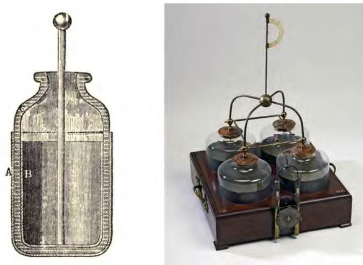
Figura 3.2 – À esquerda, desenho esquemático de 1902 do jarro de Leyden seccionado longitudinalmente: (a) cobertura metálica externa, (b) cobertura metálica interna. Ao centro, eletrodo em contato com a cobertura interna através do líquido. À direita, uma “bateria” de quatro jarros de Leyden conectados em paralelo, de 1775.
