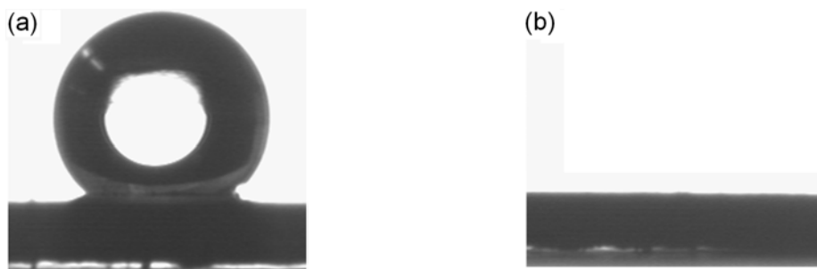
Figura 4.10 - Ângulo de contato da água em amostras de NTC. (a) NTC sem tratamento de plasma de O 2 . (b) NTC com tratamento de plasma de O 2 .
