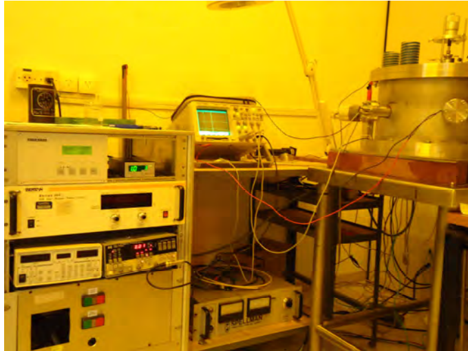
Figura 3.7 - Visão geral do sistema experimental de emissão por efeito de campo
