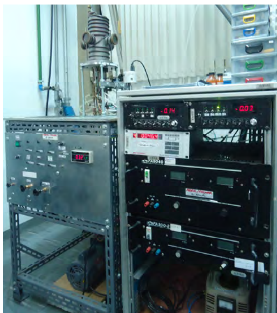
Figura 3.2 - Visão geral do sistema HFCVD
