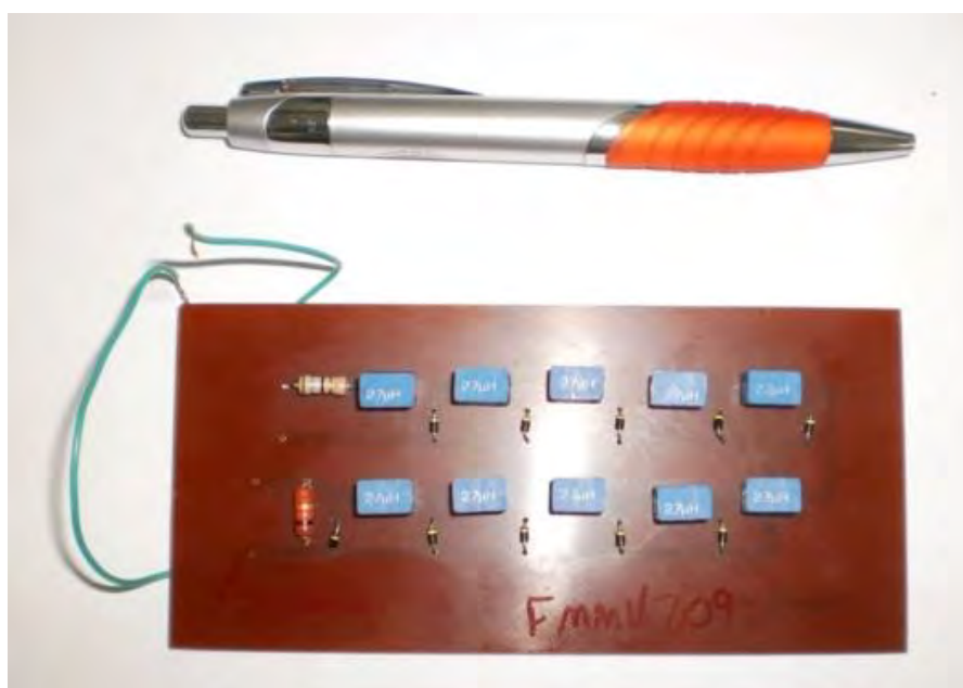
Figura 4.2 - LTNL experimental montada na PCI.
