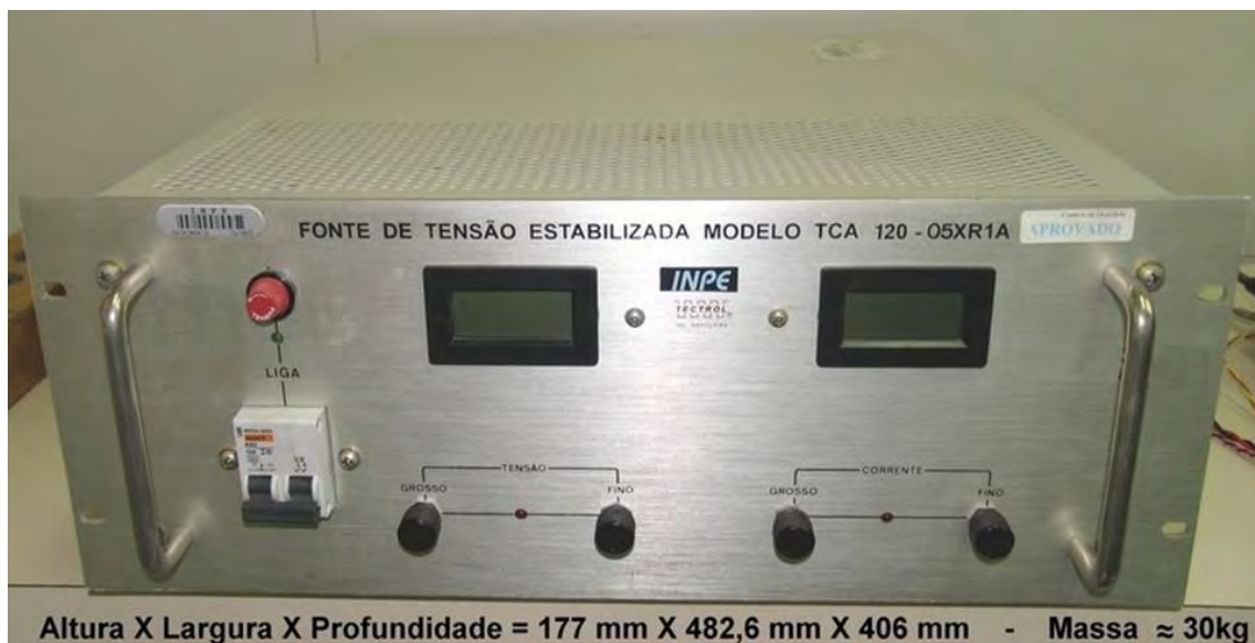
Figura 2.4 - Fonte DC para energização, via cordão umbilical, do forno na fase de pré-lançamento.
