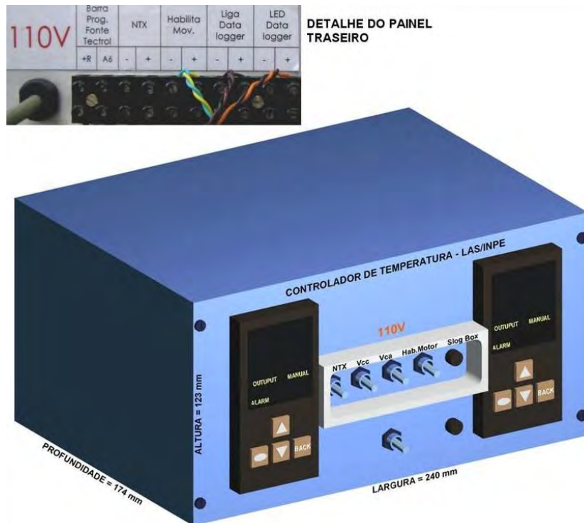
Figura 2.3 - Unidade de Controle de Temperatura do forno antes do lançamento, contendo o comando de inicialização do data-logger para aquisição de dados durante o voo e o acionamento remoto da fonte DC. No detalhe temos as diversas conexões que vão do módulo, alocado na casamata, para o cordão umbilical do veículo lançador.
