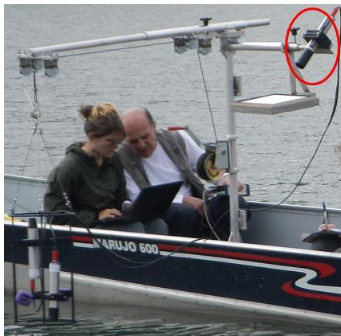
Figura 5.6: Espectroradiômetros da TRIOS em operação. Em destaque o RAMSES-ARC medindo a radiância emergente da água.
