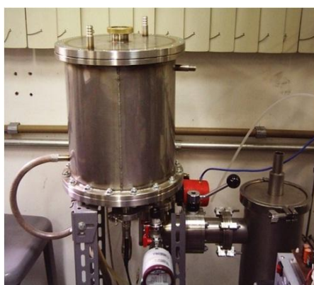
Figura 3.1 – Foto do reator de plasma DC pulsado utilizado na deposição do filme de silício amorfo.
