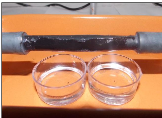
Figura 4.16 – Fotografia da membrana de VACNTs enrolada horizontalmente e utilizada no processo de filtragem entre água e óleo mineral.
