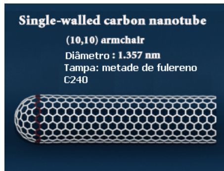
Figura 2.3 – SWCNT fechado em uma extremidade por um hemisfério fullerênico C240.
