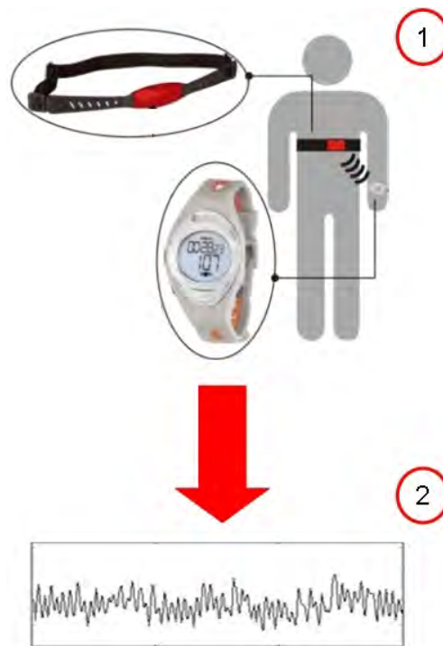
Figura 3.4 - Representação em duas etapas da captura da frequência cardíaca de um indivíduo usando o cinto Polar: 1 indivíduo usando o cinto e o relógio Polar e 2 série temporal de intervalos RR fornecida pelo equipamento.
