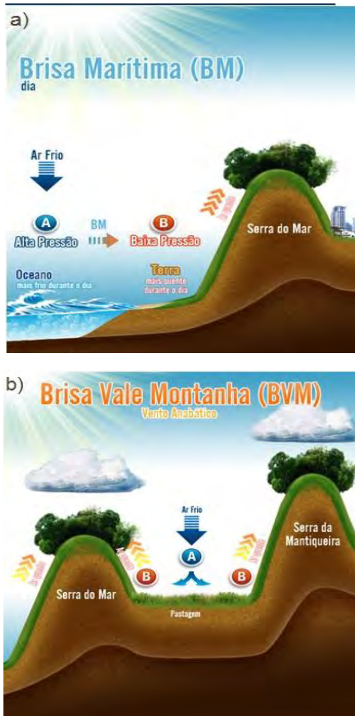
Figura 2.5 - Esquema ilustrativo para a) Brisa Marítima (oceano-continente) e b) Brisa vale-topo (brisa de vale - anabático);
