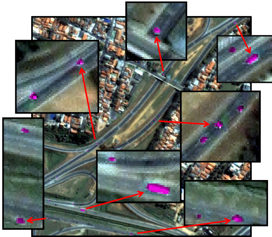
Figura 4.30 - Identificação de veículos na imagem para avaliação dos métodos quanto à capacidade de classificação de alvos pontuais. A colorização destes alvos foi editada manualmente.
