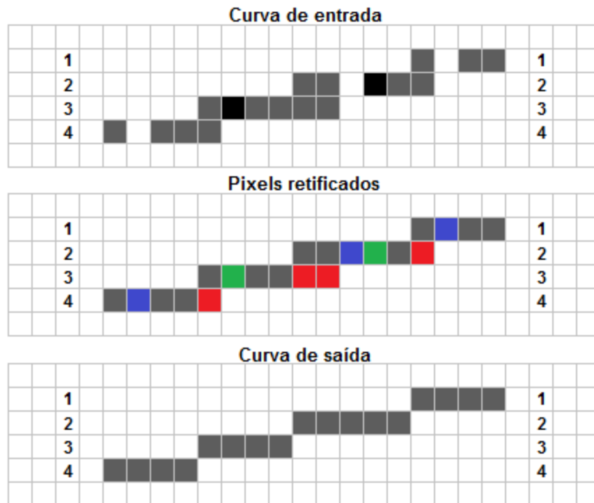
Figura 4.3 – Detalhes da operação do filtro para retificar a curva discretizada da interpolação spline cúbico paramétrico. A curva de Entrada possui em cinza os pixels preenchidos durante a discretização e em preto a sobreposição de pixels. Os pixels retificados representam os pontos que devem ser corrigidos, sendo, em azul as lacunas, em vermelhos as posições erradas e em verde a sobreposição. A curva de saída indica a curva ideal, corrigida pelo filtro.
