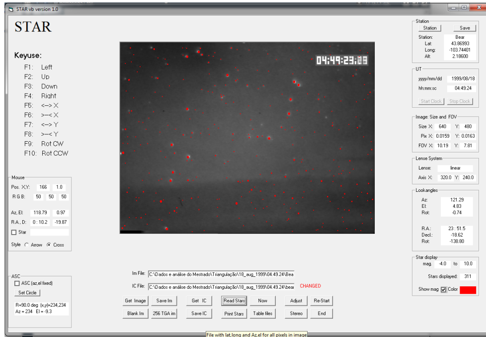
Figura 5.2 - Ajuste do mapa estelar com as estrelas da imagem. Note que a magnitude das estrelas é representada pelo tamanho e que as estrelas de menor magnitude não são visíveis na imagem da câmera devido a sua baixíssima luminosidade.
