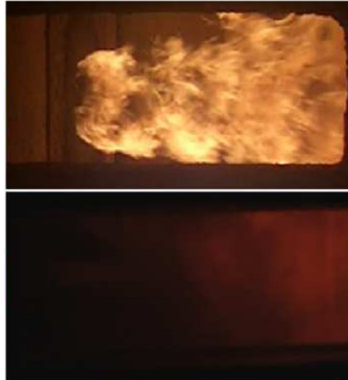
Figura 2.26 - Comparação entre combustão convencional e combustão sem chama visível obtida para a queima de diesel.
