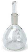
Figura A.1 - Picnômetro de 50 ml usado na medida das massas específicas dos líquidos.
