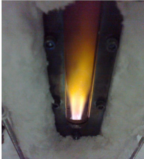
Figura 4.32 - Aspecto da chama no início do pré-aquecimento da câmara de combustão.
