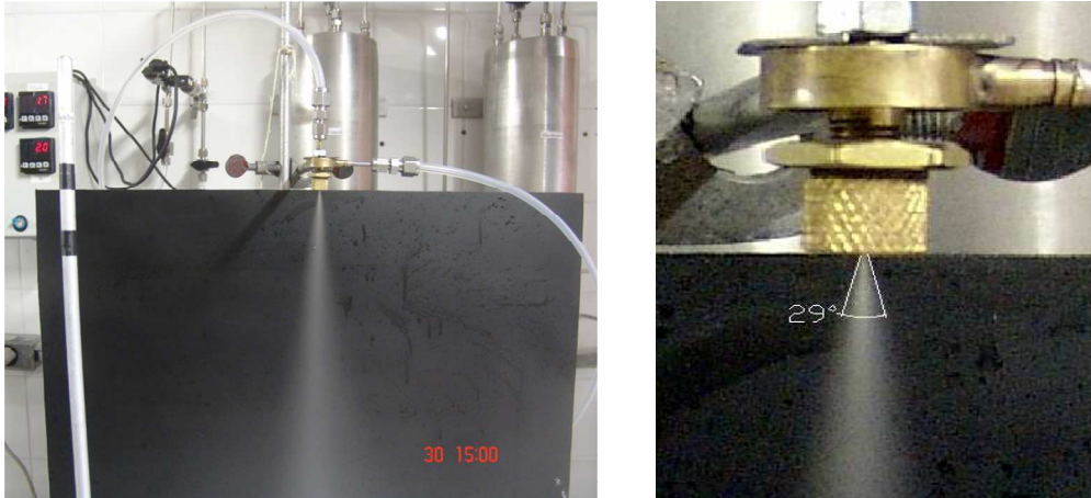
Figura 3.6 - Montagem do arranjo experimental para realizar a medição do ângulo de cone.
