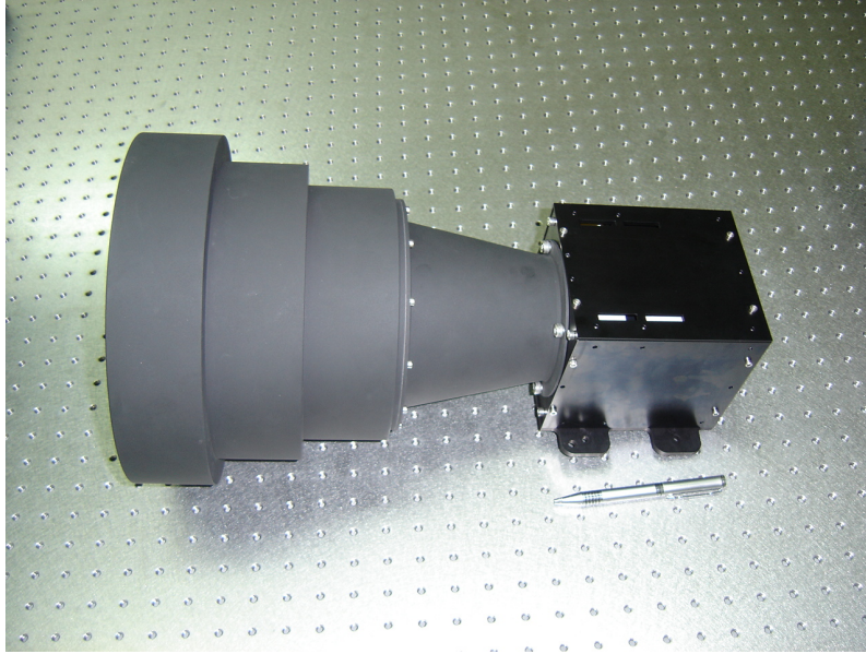
Figura 2.1 - Sensor de Estrelas Autônomo em desenvolvimento no INPE.
