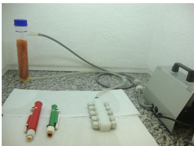
Figura 4 – Detalhes do sistema de secagem cujo circuito é composto por bomba, dois filtros impregnados com solução básica e ácida, respectivamente sílica gel laranja para retenção de umidade e “manifold” onde são acoplados 10 denuders para secagem simultânea.
