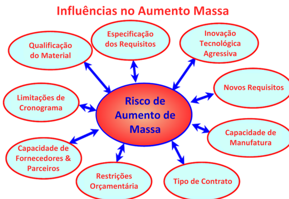
Figura 4.5 – Influências para o aumento de risco relacionado ao aumento de massa do sistema.
