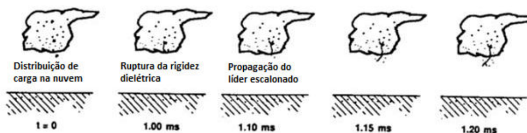
Figura 3.2 - Sequência temporal dos dois primeiros processos físicos envolvidos na formação do relâmpago nuvem-solo negativo. Fonte: adaptado de Uman (1987)
