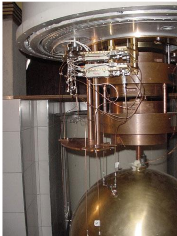
Figura 3.6 - Fotografia do detector Mario Schenberg com as câmaras criogênicas abertas.
