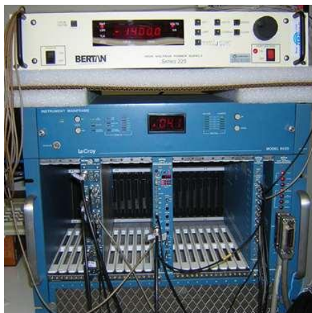
Figura 8.5 - Crate Camac LeCroy modelo 8025. Acima do crate esta a fonte de alta tensão Bertan. Os módulos Camac (da esquerda para direita) são: Linear Fan-In Fan-Out LeCroy mod. 428F; Programable Dual Gate Generator LeCroy mod. 2323A; ADC LeCroy mod. 2249W; Crate Crontrroller CAMAC-GPIB LeCroy mod.8901A.
