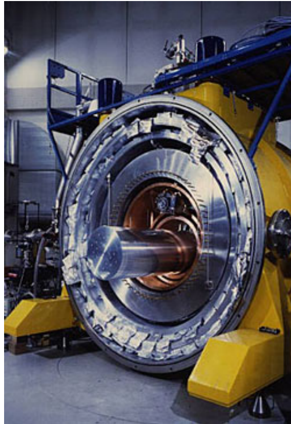
Figura 3.2 - Detector AURIGA. Nesta imagem o detector está pronto para ser introduzido no sistema de vácuo
