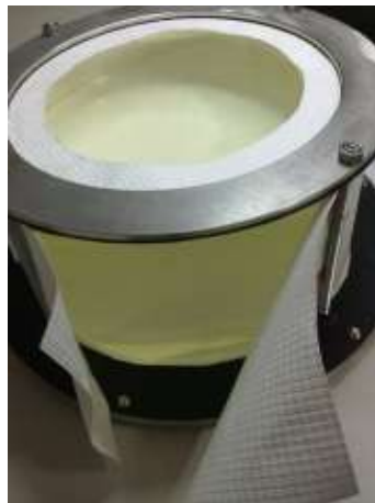
Figura 8.3 - Cintilador sendo envolto pela folha de Tyvek.
