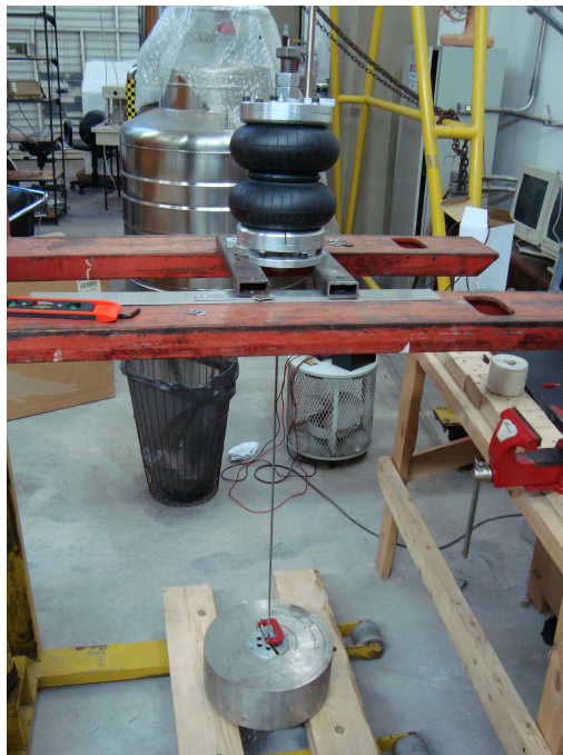
Figura 6.9 - Mola de Gás suspendendo, através da haste, uma massa de aproximadamente 60 kg.
