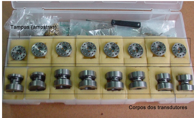
Figura 3.2 - Conjunto de oito transdutores paramétricos, da sexta geração, desenvolvidos para próxima corrida do detector Mario Schenberg. Nesta imagem, as cavidades estão abertas e as “tampas” podem ser vistas separadas dos corpos dos transdutores.
