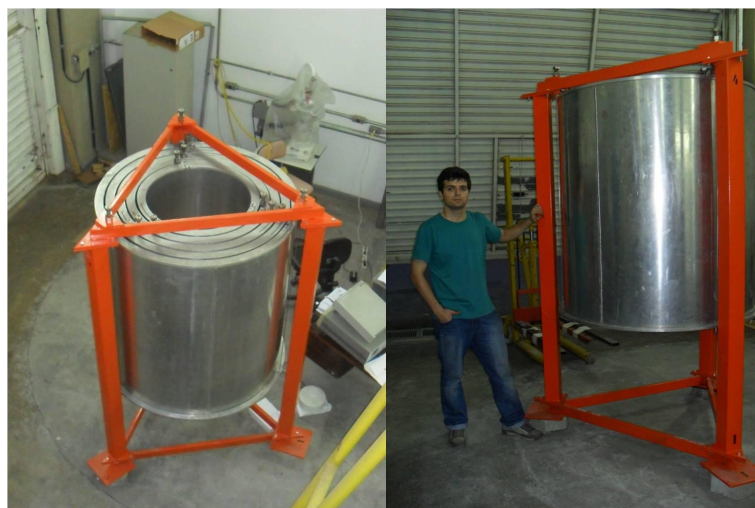
Figura 5.10 - Multi-Nested Pendula montando. À esquerda, visão superior do sistema. À direita é possível obter uma noção da altura do mesmo. Fonte: ConstancioJr (2013)
