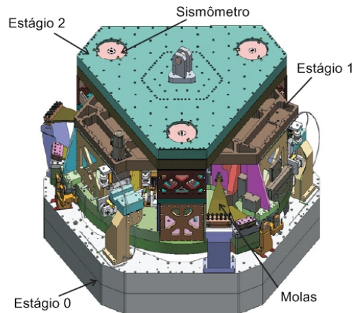
Figura 5.7 - Plataforma de isolamento ativo: subsistema de isolamento sísmico interno à câmara de vácuo. O estágio 0 é apoiado pelo subsistema externo. O estágio 1 é apoiado pelo estágio 0 através de lâminas de aço que funcionam como molas. E o estágio 2 é similarmente apoiado pelo estágio 1. Fonte: Adaptada de Harry et al. (2010) .
