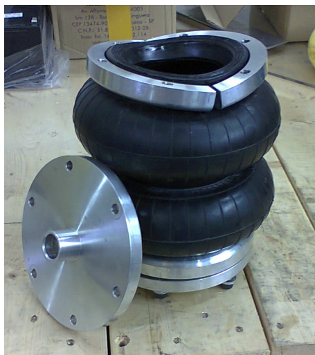
Figura 6.7 - Estrutura externa do protótipo da mola de gás: fole com os anéis encaixados e a tampa superior ao lado do fole.
