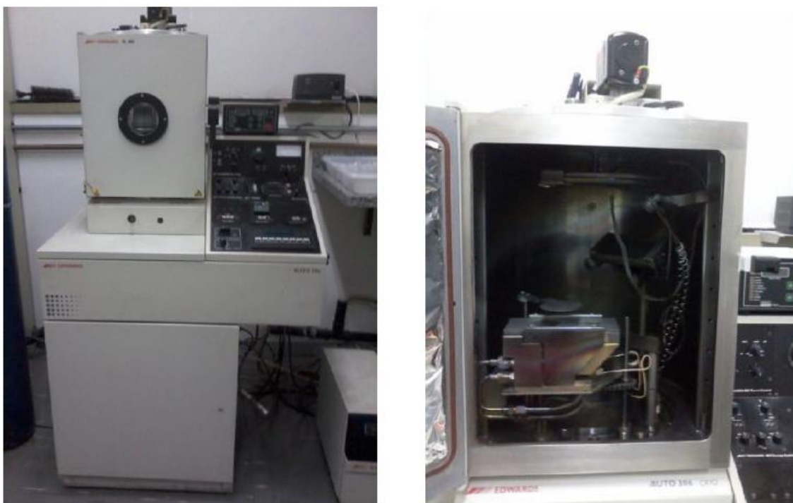
Figure 3.2 - Aparelho utilizado para realizar a técnica de EB-PVD para metalização da parte de trás das amostras de Si.
