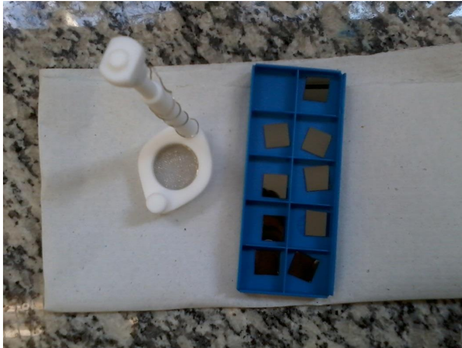
Figure 3.1 - Rede de platina (Catodo) e amostras de silício monocristalino, antes do processo de obtenção do PS por ataque eletroquímico.
