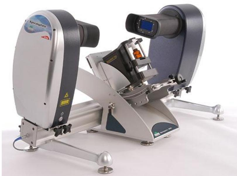
Figura 9.4 - Sistema de difração laser *Spraytec* da empresa Malvern.
