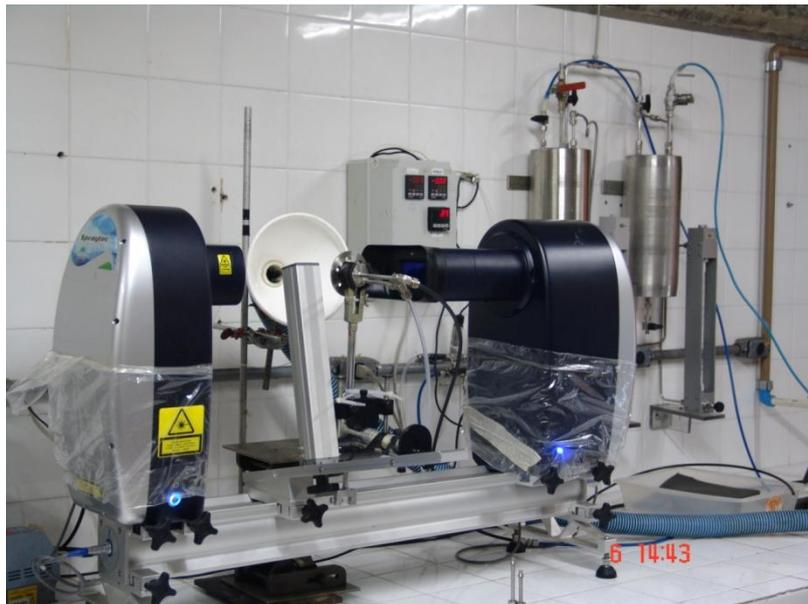
Figura 6.8 - O sistema de difração laser *Spraytec Malvern 2007*.
