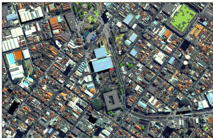
Figura 5.14 - Coleta de amostras das classes coberturas metálicas, vegetação rasteira, solo exposto e sombra.
