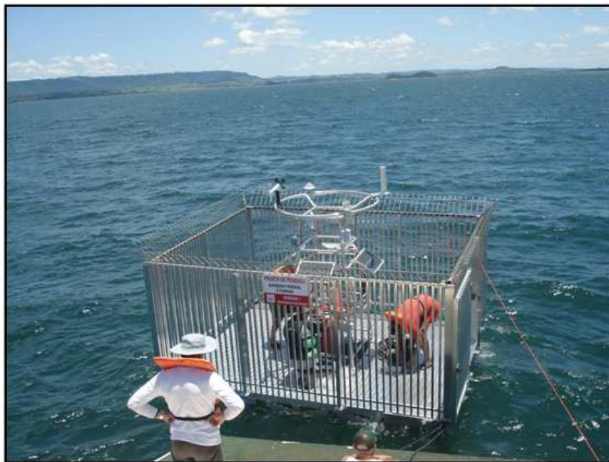
Figura 6.12: Bóia SIMA-II instalada na região próxima a confluência dos rios no Reservatório de Itumbiara por meio do Projeto INCT para Mudanças Climáticas.
