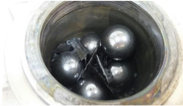
Figura 2. Jarro do moinho com as esferas de moagem e o material processado em seu interior
