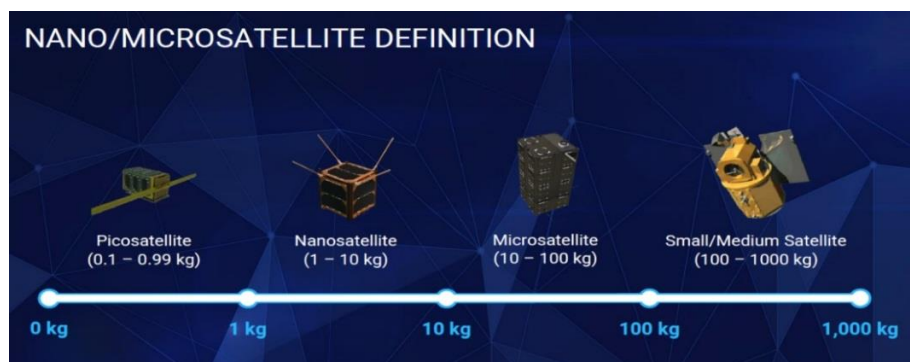
Figura 1: Classificação dos Satélites por massa Fonte: Retirado de SPACEWORKS , (2020)
