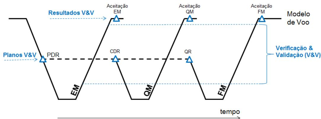
Figura 2: Representação modelo do ciclo de vida adaptado aos modelos de satélites.
