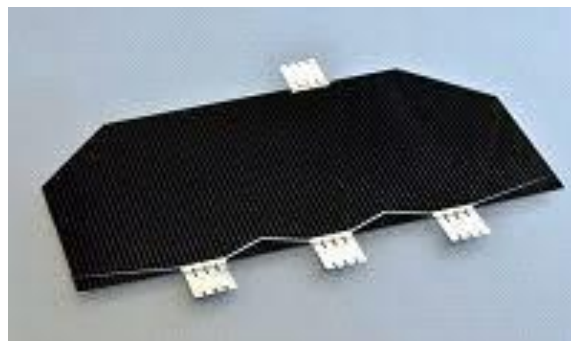
Figura1. Interconectores soldados à uma célula solar espacial. [Fonte: Strobl et al., 2014].
