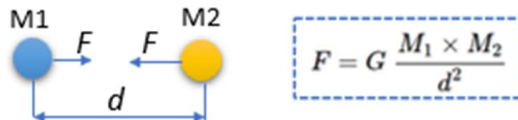
Figura 11: matéria atrai matéria com uma força diretamente proporcional ao produto de suas massas e inversamente proporcional ao quadrado da distância entre elas.
