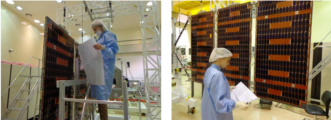
Figuras 6 e 7. Inspeções Visuais do Gerador Solar (SAG) no Laboratório de Integração e Testes (LIT) do INPE [MAIOLINO, 2013].
