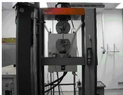
Figura 7 – Máquina de ensaios de tração utilizada para os ensaios de tração, pertencente à Divisão de Química – Instituto de Aeronáutica e Espaço – DCTA [10].
