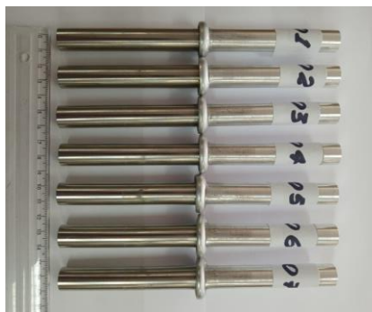
Figura 4. Corpos de prova soldados pelo processo de soldagem por fricção rotativa a serem analisados. [Fonte: Autor]
