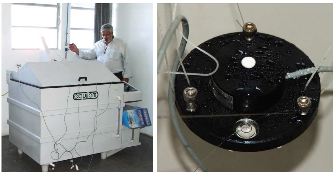
Figura 65 - Ensaio ambiental de nevoa salina. Esquerda: câmara de névoa salina. Direita: radiômetros dentro da câmara.
