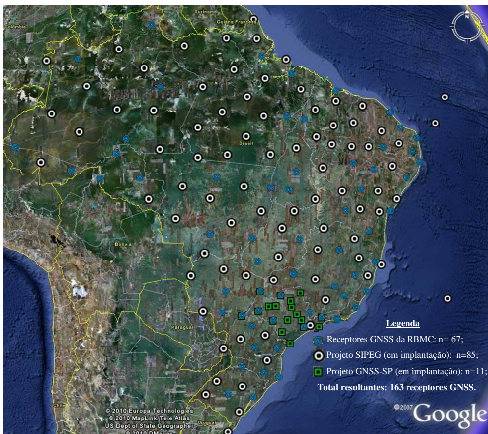
Figura 1 – Configuração da rede GNSS no Brasil depois das densificações em andamento.
