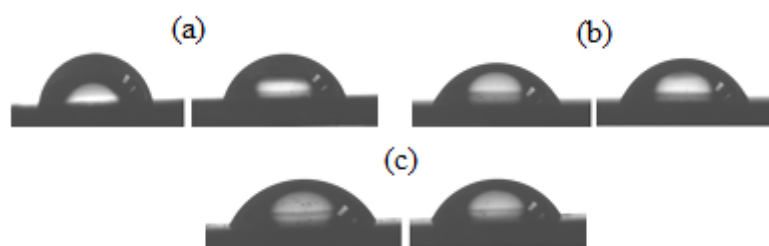
Figura 4.4: Ângulos de contato das amostras, (a) NDD02, (b) NDD04 e (c) NDD06.
